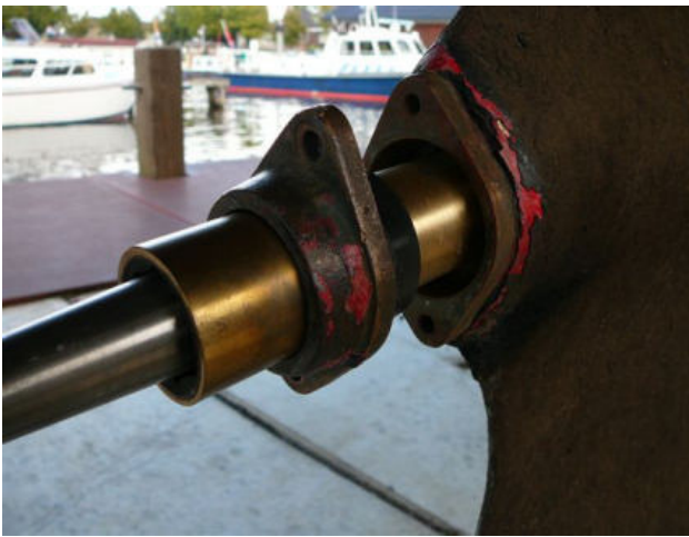
foto 11: Het nieuwe achter schroefaslager.
