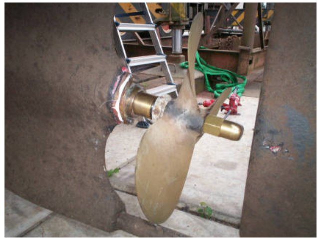
foto 12: Het achterlager aangebracht.
