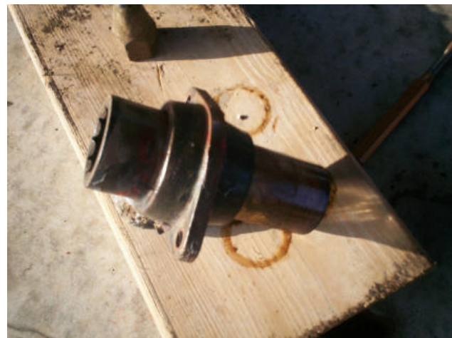
foto 8: Oud schroefaslager gedemonteerd.
