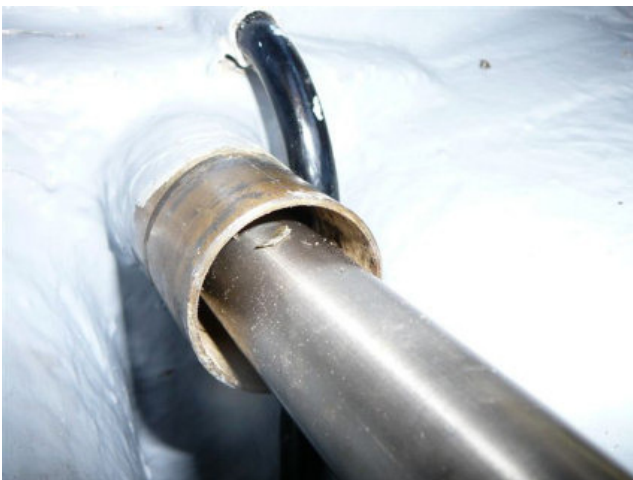
foto 13: Binnenzijde schroefaskoker met 30mm.schroefas.
