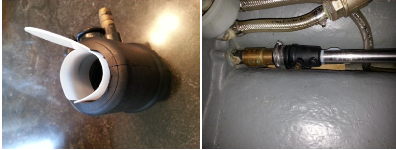
De beschermingslip aan gebracht De seal voorzichtig op de as geschoven
